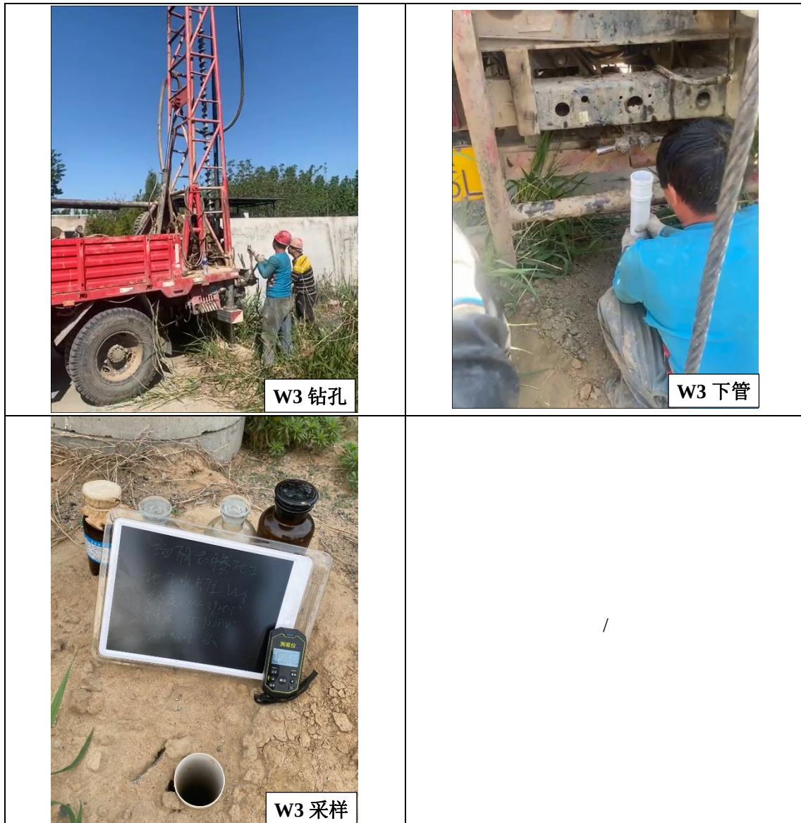
图 4.2-2 地下水现场采样照片
