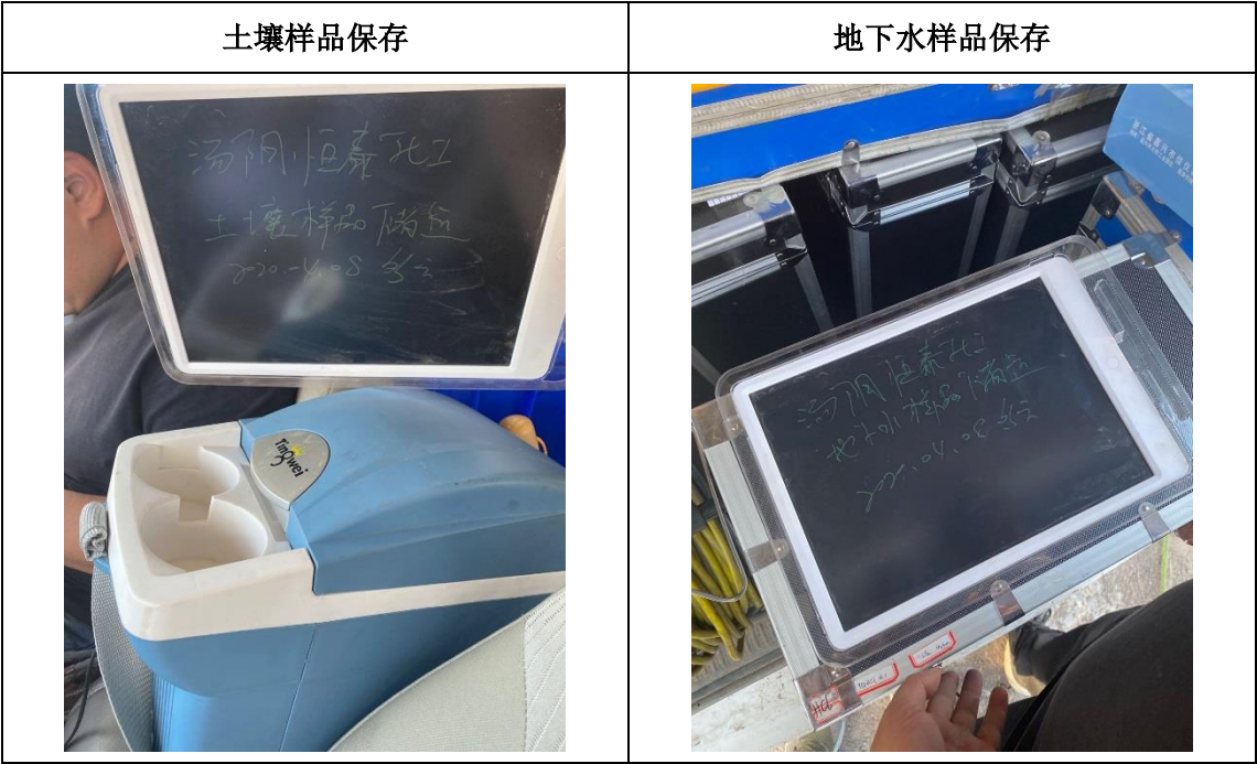
图 4.2-3 土壤、地下水样品保存
